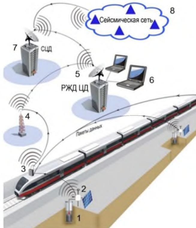
1 – сейсмический датчик; 2 – система электропитания, локального сбора, передачи и хранения сейсмических данных; 3 – система мобильного сбора сейсмических данных (приема-передачи и хранения), установленная внутри поезда; 4 – мачта сотовой связи; 5 – Центр данных РЖД (РЖД ЦД); 6 – автоматическая обработка данных; 7 – Сейсмологический центр данных (СЦД); 8 – региональная сейсмическая сеть, действующая в регионе
