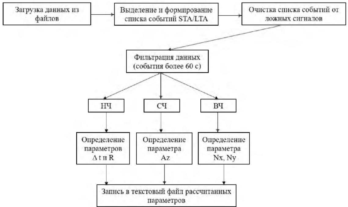
Рисунок 4.4.1 – Схема предварительной обработки
